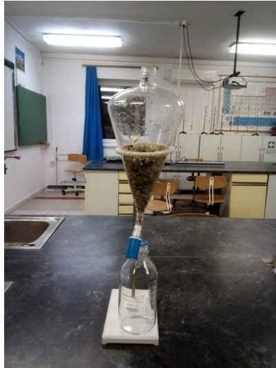
1. Kép: Kavicsszűrő két szemcsemérettel. Készítette: Parrag Tamás
