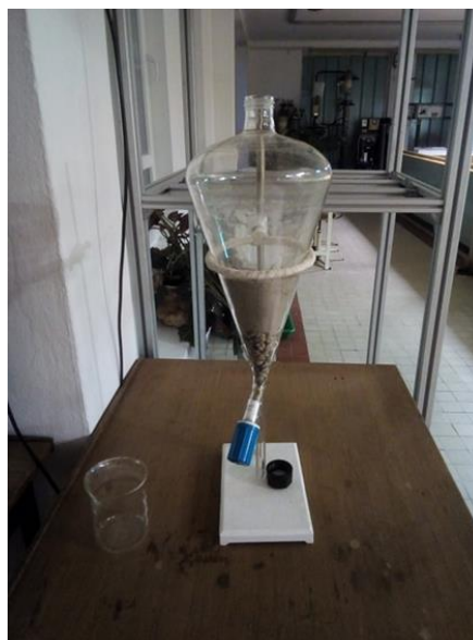
2. Kép: Homokszűrő kavics támasztóréteggel Készítette: Parrag Tamás
