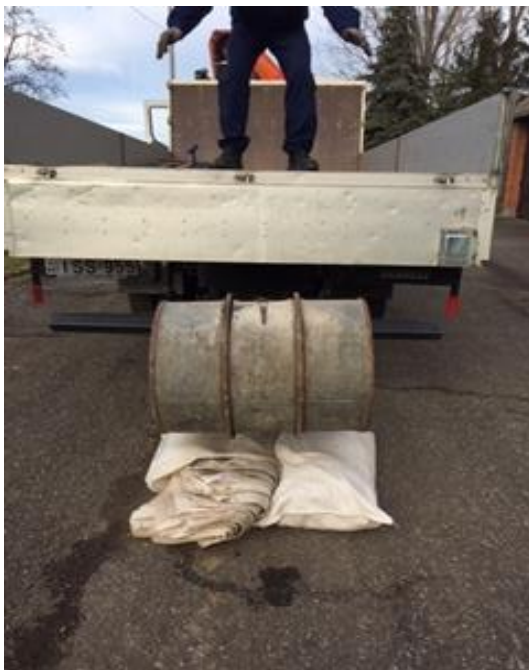
13. kép: Hordó ejtésének tompítása homokzsákokkal, készítették a szerzők
