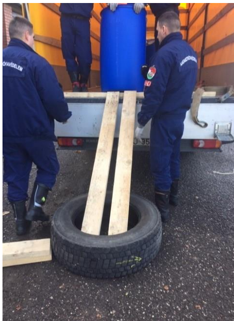
14. kép: Hengeres tárgy platóról történő biztonságos lehozatala I. lépés, készítették a szerzők
