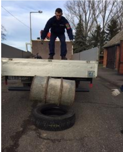
12. kép: Hordó ejtésének tompítása, készítették a szerzők
