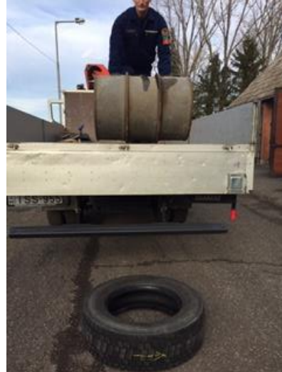
12. kép: Hordó ejtésének tompítása, készítették a szerzők
