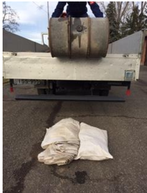
13. kép: Hordó ejtésének tompítása homokzsákokkal, készítették a szerzők
