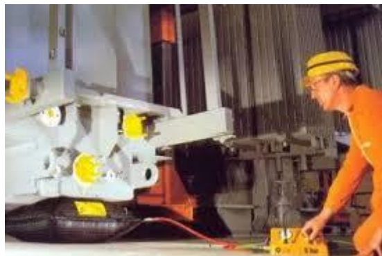
20. kép pneumatikus emelő alkalmazási vasúti szerelvény emelésekor [38] készítette: Vettel GMBH.
