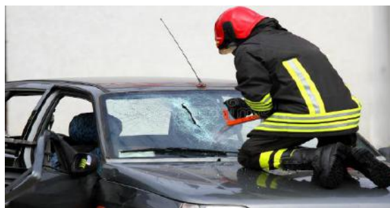
2. kép: Szélvédővágás fűrésszel [2]
