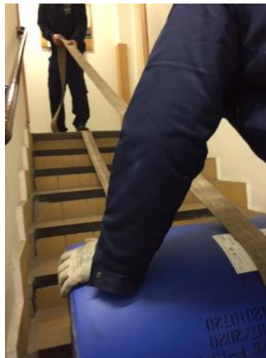
9. kép Hordó mozgatása tömlő segítségével, készítették a szerzők
